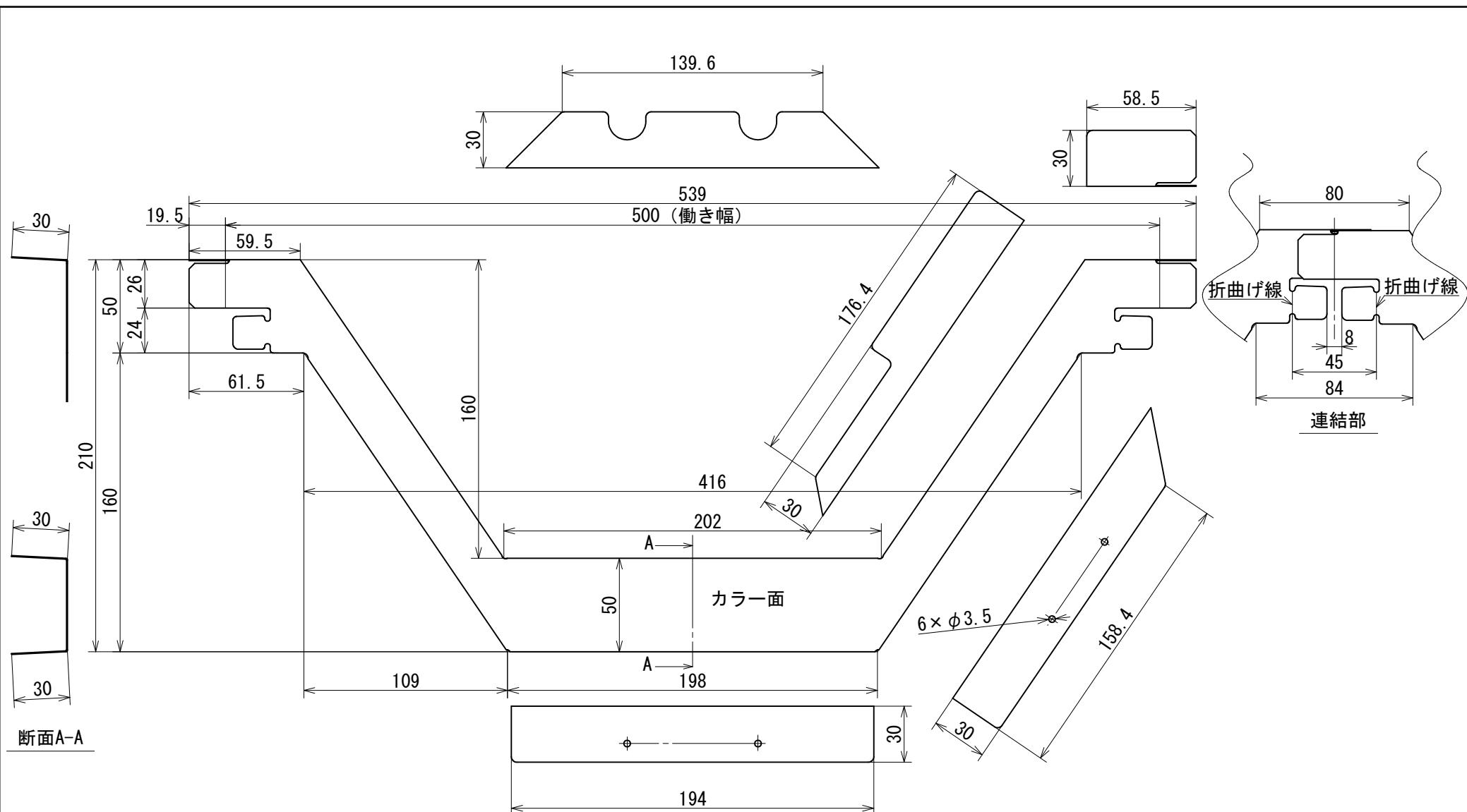
特記事項・連結部のハゼ部に干渉する側を折曲げ線上で折曲げる
